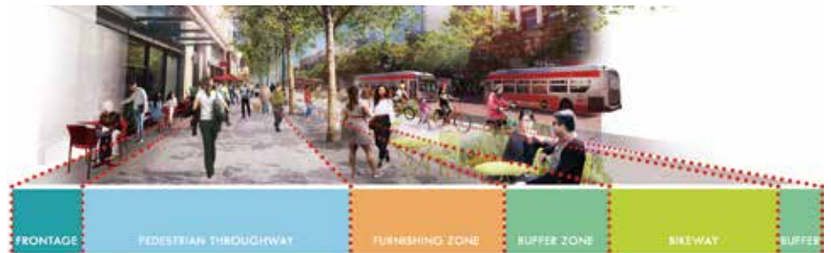
マーケットストリートの道路断面図 (米国・サンフランシスコ市)
